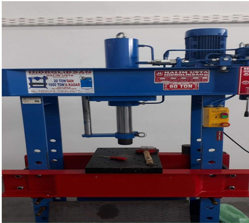
Şekil 11. Tozların preslenmesinde kullanılan hidrolik pres.
