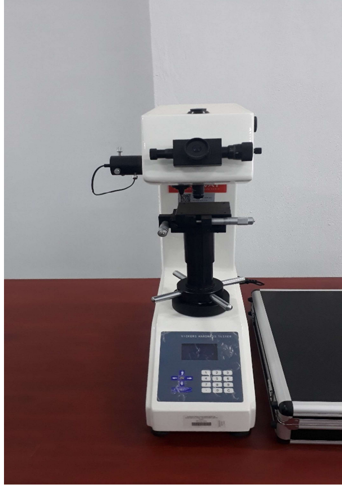
Şekil 15. Sertlik ölçümlerinde kullanılan cihaz.
