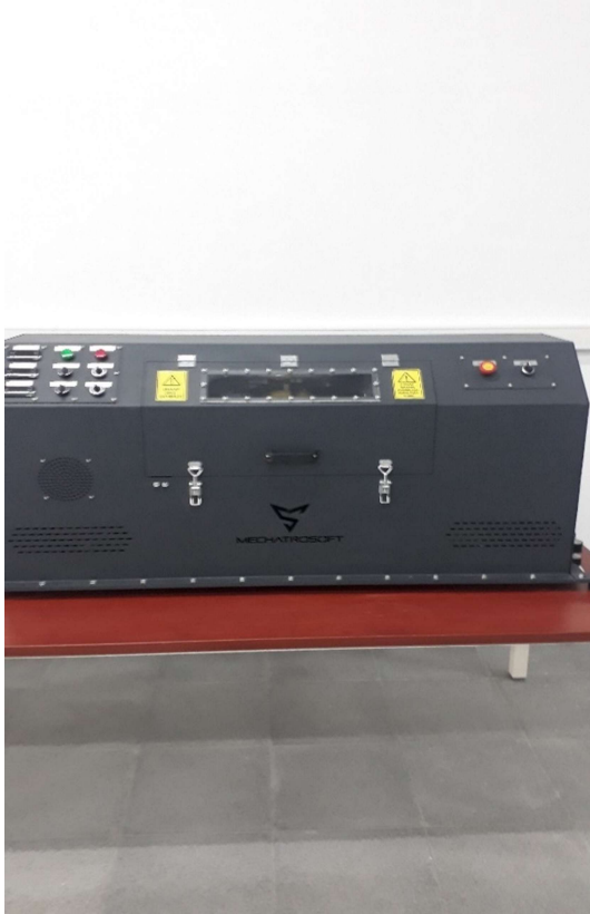
Şekil 10. Toz karışımlarının karıştırılmasında kullanılan karıştırıcı.
