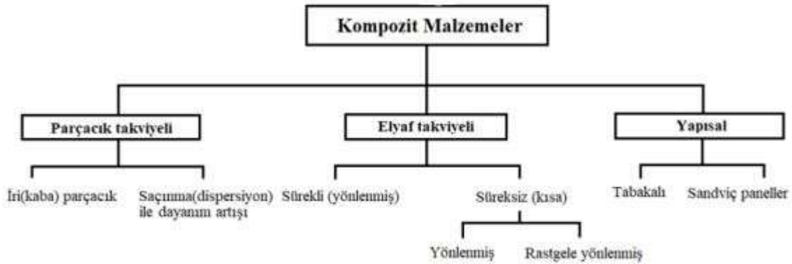
Şekil 3. Kompozit malzemelerin takviyesine göre sınıflandırılması [24].
