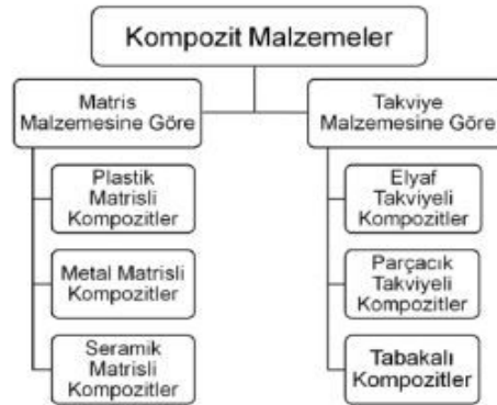
Şekil 4. Kompozit malzemelerin malzemesine göre sınıflandırılması [25].
