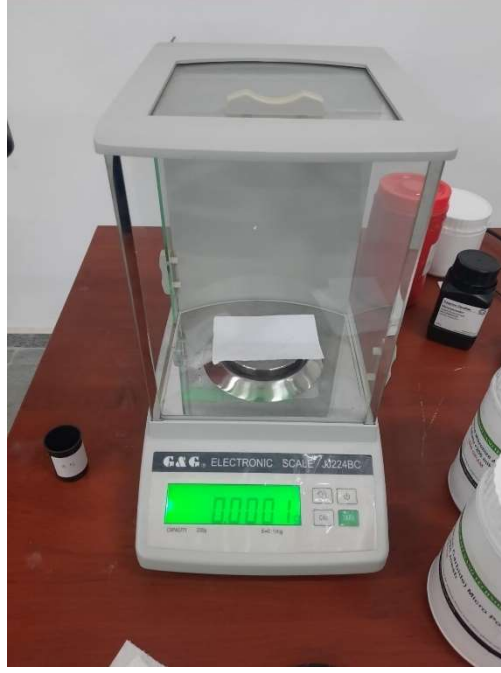
Şekil 9. Toz karışımlarının hazırlanmasında kullanılan hassas terazi.
