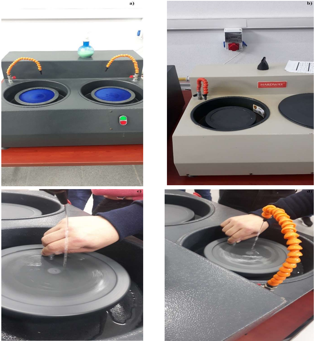
Şekil 14. Parlatma ve zımparalama işleminde; a) ve b) kullanılan makineler, c) ve d) işlem gören numuneler.
