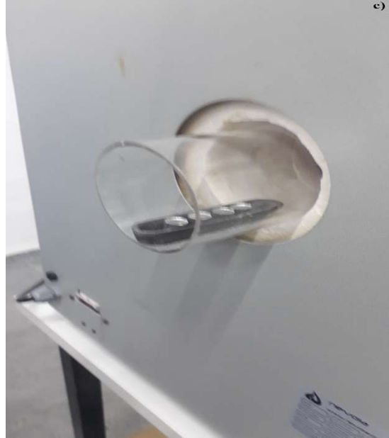
Şekil 13. Sinterleme işleminde; a) Kullanılan fırın. b) ve c) Sinterlenmek üzere fırın içerisine yerleştirilmiş olan numuneler.
